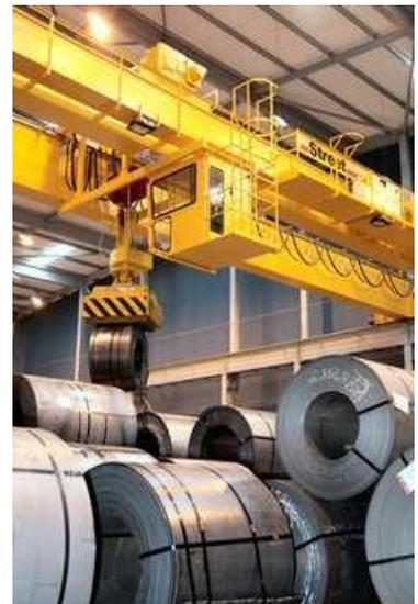
Die zu bewegenden Stahlrollen wiegen zig Tonnen und werden mittels Brückenkränen versetzt.
