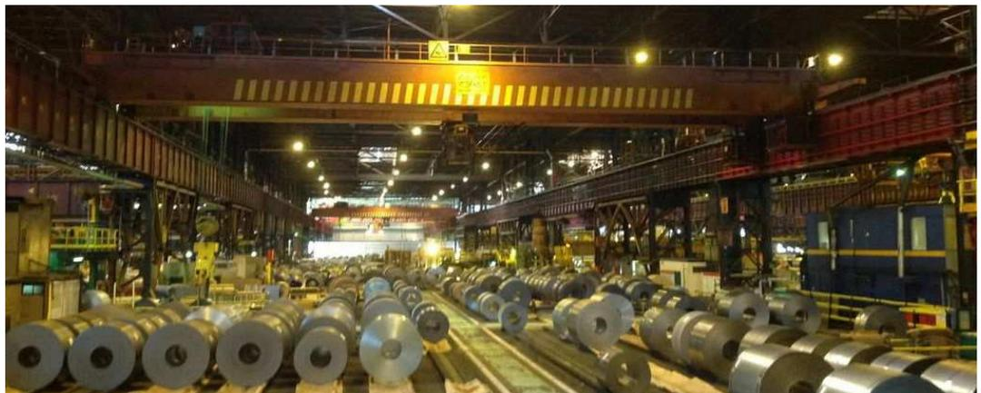
ArcelorMittal Gent verfügt über ca. 30 km Kranbahnträger und ca. 240 Brückenkräne mit Gewichten zwischen 40 und 460 Tonnen.
