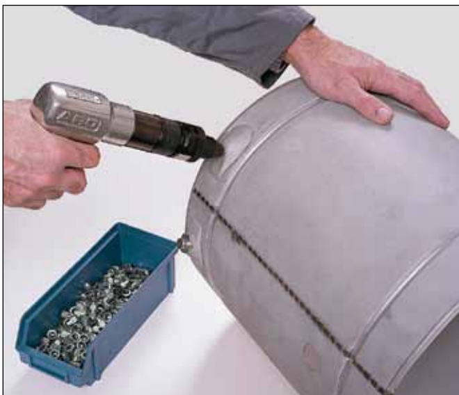
Abb. 5: Einseitige Montage. Das Werkzeug wird auf dem Produkt angesetzt.
