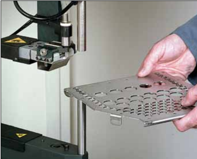
Abb. 8: Beidseitige Montage. Das Produkt wird zur Presse gebracht.
