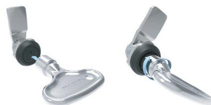
Zuerst die Verschlussblende mit dem Schlüssel nach innen drücken und anschließend mit einer Drehung den Riegel öffnen oder schließen.
