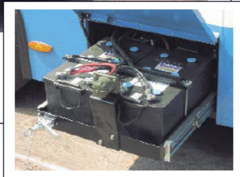
Accuride® Teleskopschienen in einem Verkehrsbus – Typ 0522. Stoß – und vibrationsresistent in mobilen Anwendungen
